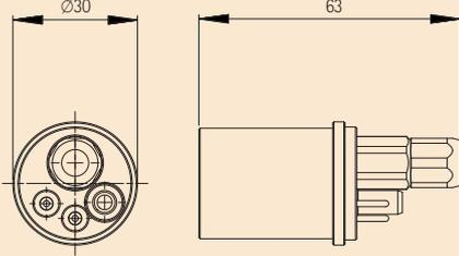
Zentraladapter pistolenseitig, gasgekühlt, 2 Kontakte, (keine Federkontakte) M11x1 - 57134
