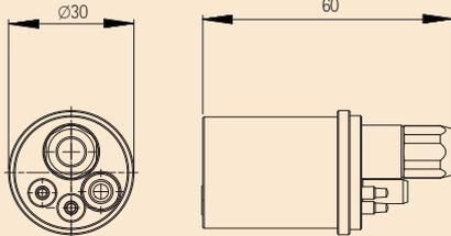
Zentraladapter pistolenseitig, gasgekühlt, 2 Kontakte, (Federkontakte) M12x1 - 57113
