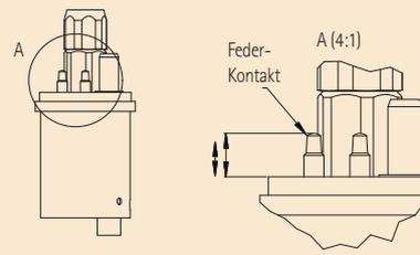
Zentraladapter pistolenseitig, gasgekühlt, 2 Kontakte, (Federkontakte) M11x1 - 57125
