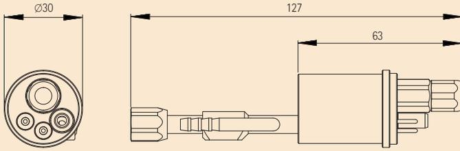
Zentraladapter pistolenseitig, wassergekühlt, 2 Kontakte, (keine Federkontakte) M12x1 - 57097
