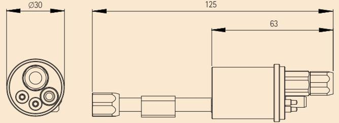
Zentraladapter pistolenseitig, gasgekühlt, 2 Kontakte, (keine Federkontakte) M12x1 - 57096
