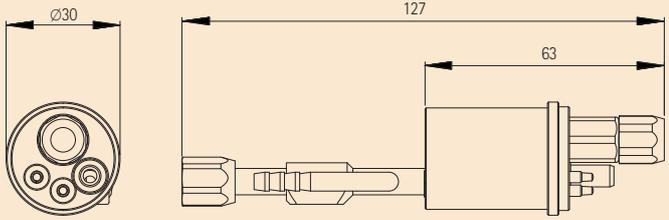
Zentraladapter pistolenseitig, wassergekühlt, 2 Kontakte, (Federkontakte) M12x1 - 57141
