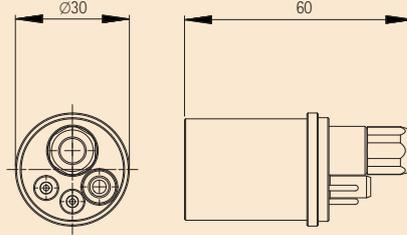
Zentraladapter pistolenseitig, wassergekühlt, 4 Kontakte, (keine Federkontakte) M12x1 - 57094
