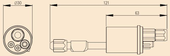
Zentraladapter pistolenseitig, wassergekühlt, 2 Kontakte, (Federkontakte) M12x1 - 57341
